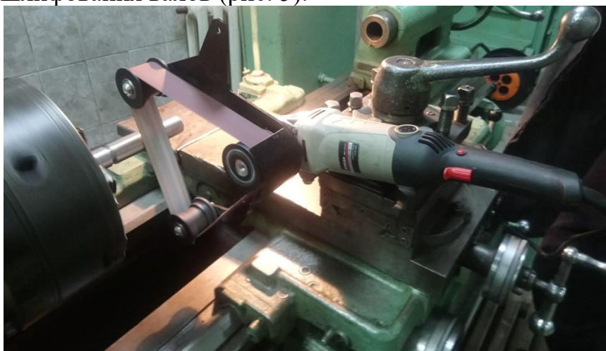
Рис. 5. Модуль для ленточного шлифования на токарном станке на основе УШМ-125, работающий по схеме прижатия свободной ленты к заготовке.
