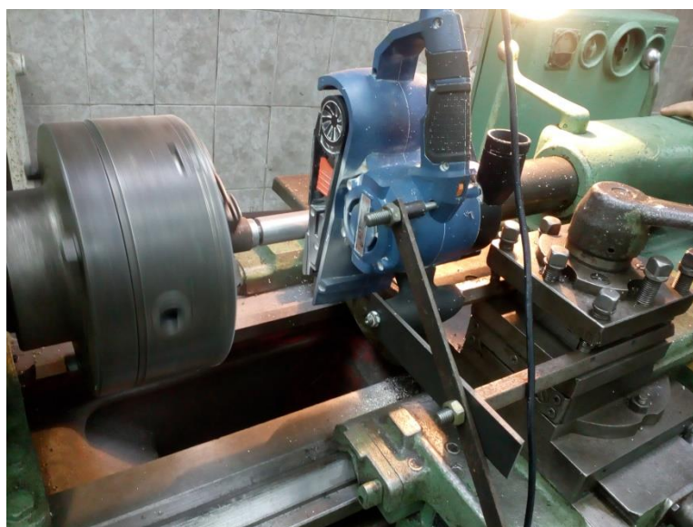
Рис. 1. Внешний вид съёмного модуля для ленточного шлифования на токарном станке 1K62 по схеме с неподвижным плоским упором.
