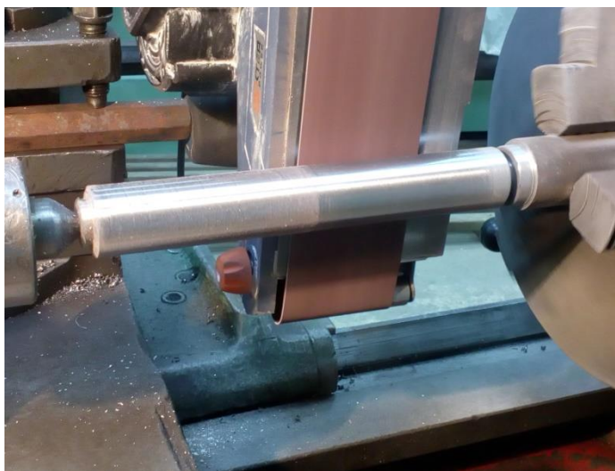
Рис. 2. Заготовка в процессе ленточного шлифования на токарном станке 1К62 по схеме с неподвижным плоским упором.
