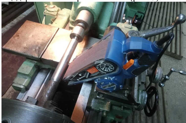
Рис. 3. Модуль для ленточного шлифования на токарном станке 1К62 по схеме с прижатием заготовки к вращающемуся ролику.
