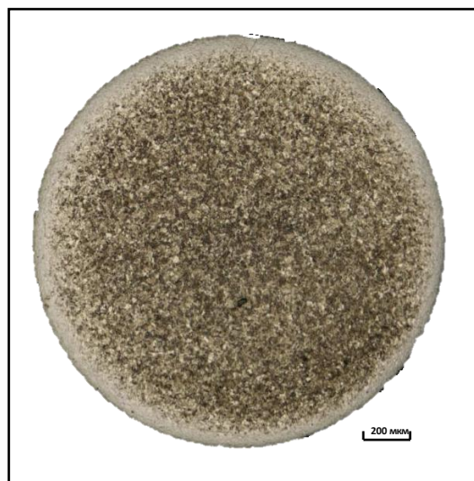
Рисунок 1 – Микроструктура проволоки из стали ВНС-9Ш после холодного волочения на диаметр 0,36 мм
