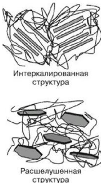
Рисунок 2 - Схематическая иллюстрация двух различных типов нанокомпозитов на основе полимера и слоистого силиката
