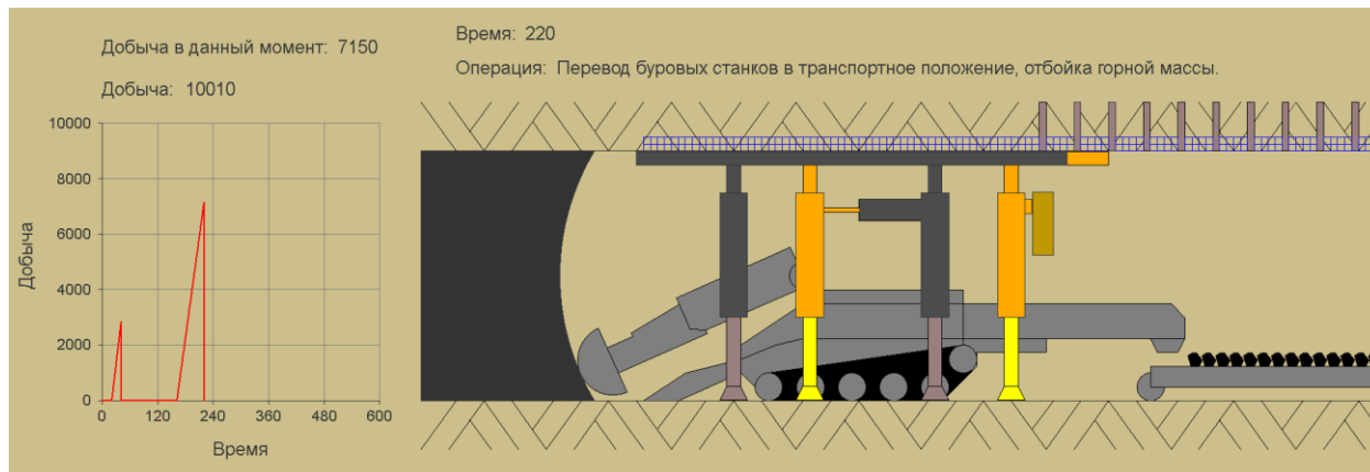
Рисунок 3 – Отображение работы технологии скоростной проходки горных выработок
