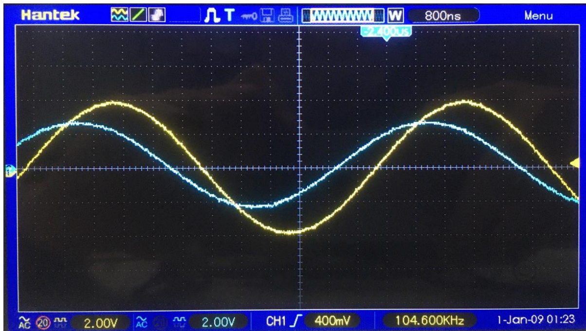
Рис. 3. Осциллограмма напряжения на колебательном контуре 0,7U_{рез}
