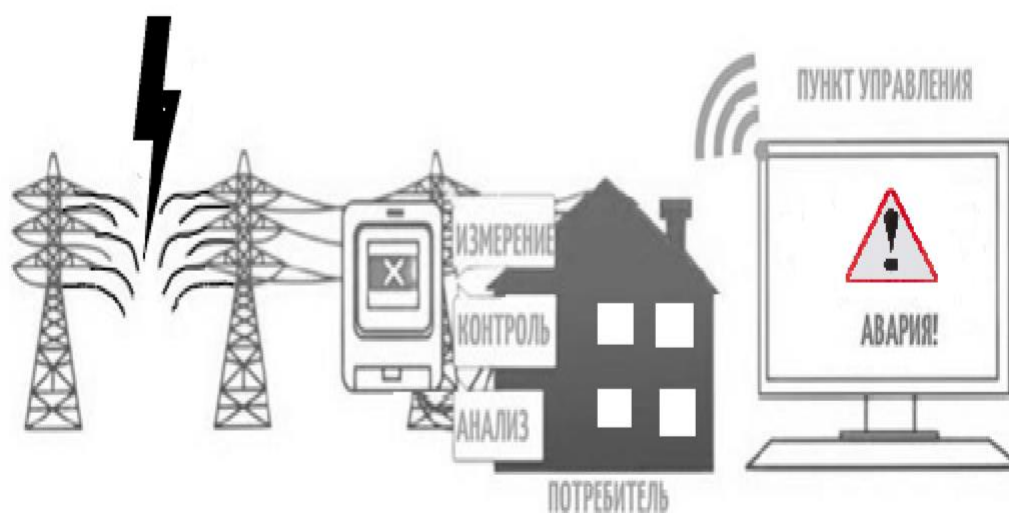
Рисунок 1 – Принцип работы «умных» приборов учета электроэнергии
