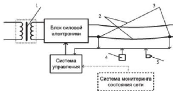
Рисунок 10. Система электромеханического воздействия на провода воздушной линии для удаления гололеда: 1 - силовой трансформатор 2 - провода; внешние датчики гололедно-ветровых нагрузок 3, влажности 4 и температуры 5
