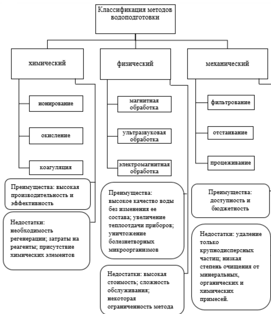
Рисунок 2 - Классификация основных методов сетевой водоподготовки систем ГВС
