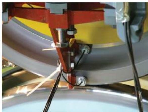
Рис.5. Магнитострикционный датчик перемещения отклонения подвески под действием вертикальных сил (момент срабатывания)
