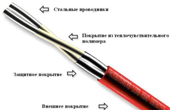
Рис.1. Конструкция термокабеля PHSC.
