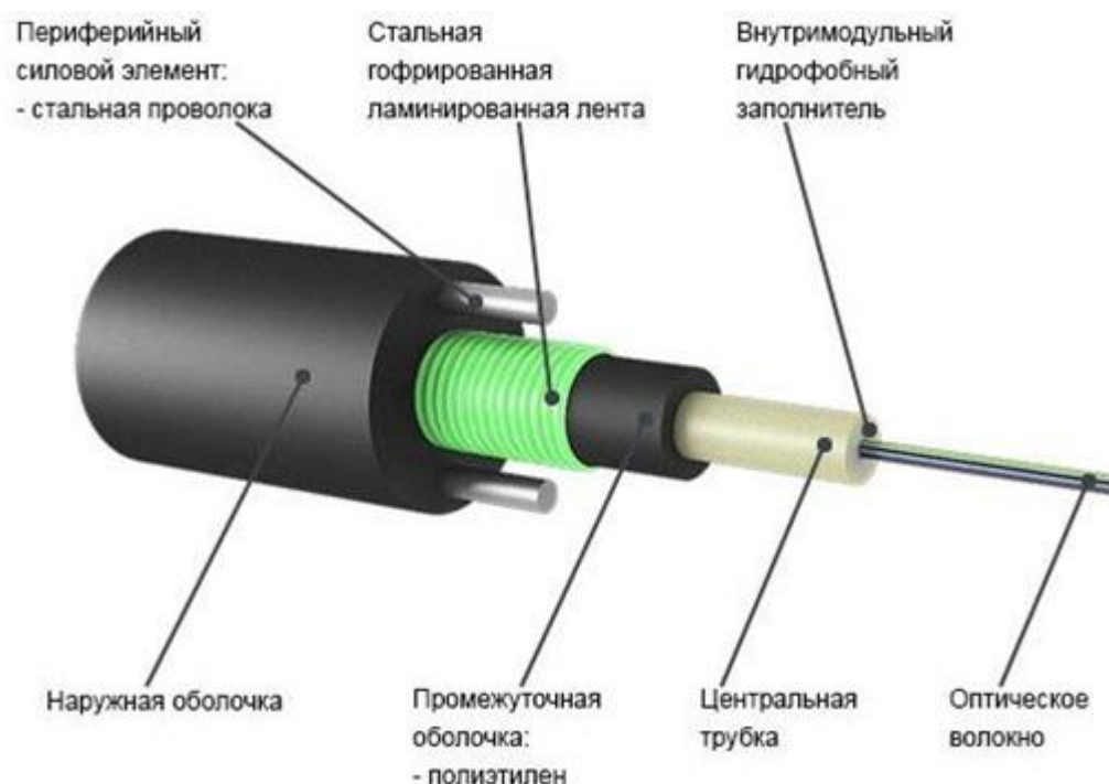
Рис. 4. Конструкция оптоволоконного кабеля
