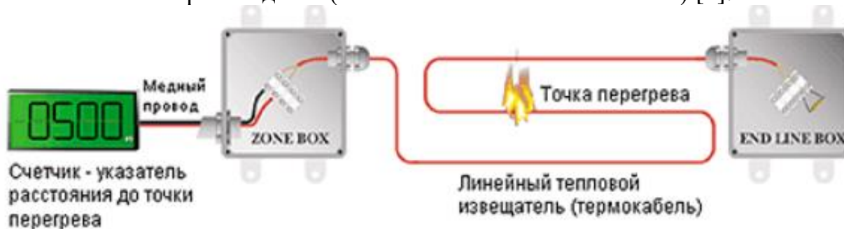
Рис. 3. Схема подключения линейного теплового пожарного извещателя к интерфейсному модулю
