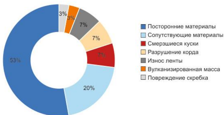
Рис.1. Причины разрыва ленты конвейера
