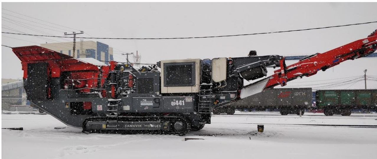
Рисунок 1 – СДСУ QI441 «Разреза «Виноградовский» - филиала АО «КТК» производства Sandvik (Швеция)
