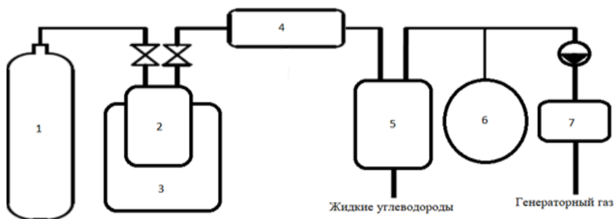
Рис. 2. Схема установки: 1 – баллон; 2 – реактор; 3 – муфельная печь; 4 – холодильник; 5 – сепаратор-отделитель; 6 – барабанный счётчик; 7 – газоанализатор
