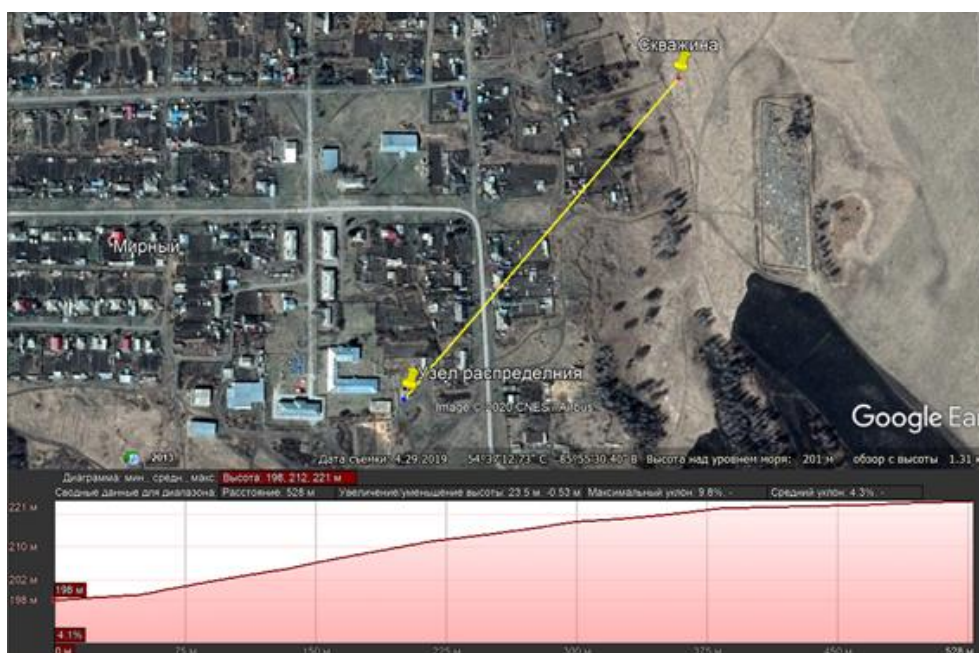
Рис. 2. Профиль рельефа участка сети до распределительного пункта
