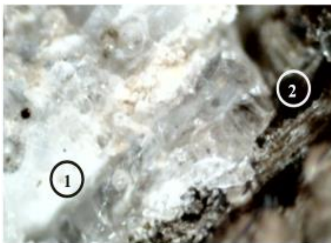
Рис. 1. Плотное прилегание сорбирующего материала к ядру. 1 – ядро; 2 – сорбирующий материал
