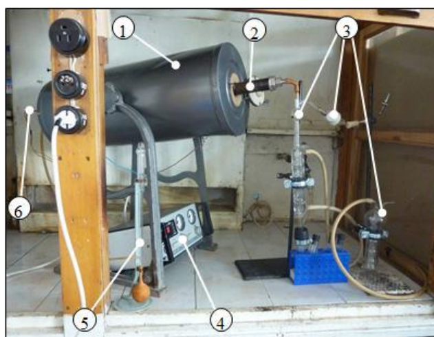
Рис. 2. Экспериментальная пиролизная установка для получения нефтесорбента: 1 – трубчатая печь; 2 – реактор-пиролизер; 3 – система охлаждения и газоочистки; 4 – блок управления; 5 – пенный расходомер; 6 – датчик температуры
