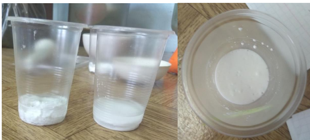
Рис. 1. Изучение тампонажной смеси, полученной термохимическим способом с добавлением хлорида кальция
