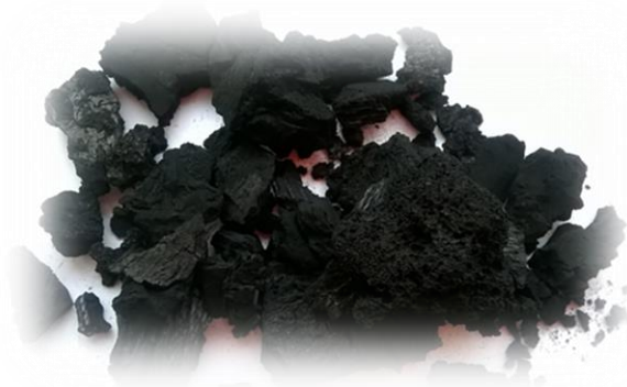
Рис. 1. Внешний вид твердого углеродсодержащего остатка пиролиза автошин
