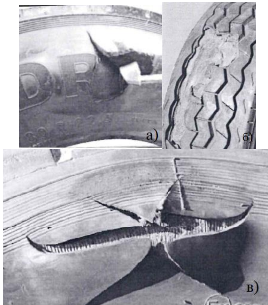
Рис. 3 а) Расслоение на боковине; б) Отслоение дорожки протектора; в) Отслоение резины боковины от нитей корда каркаса с лучевыми разрывами резины боковины
