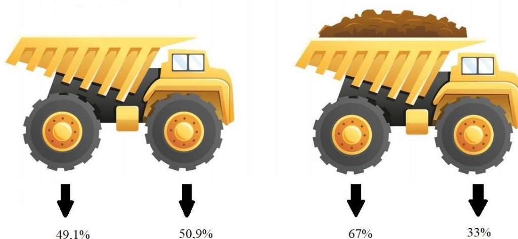
Рис. 5 – Распределение нагрузки на шины на прямолинейном участке дороги
