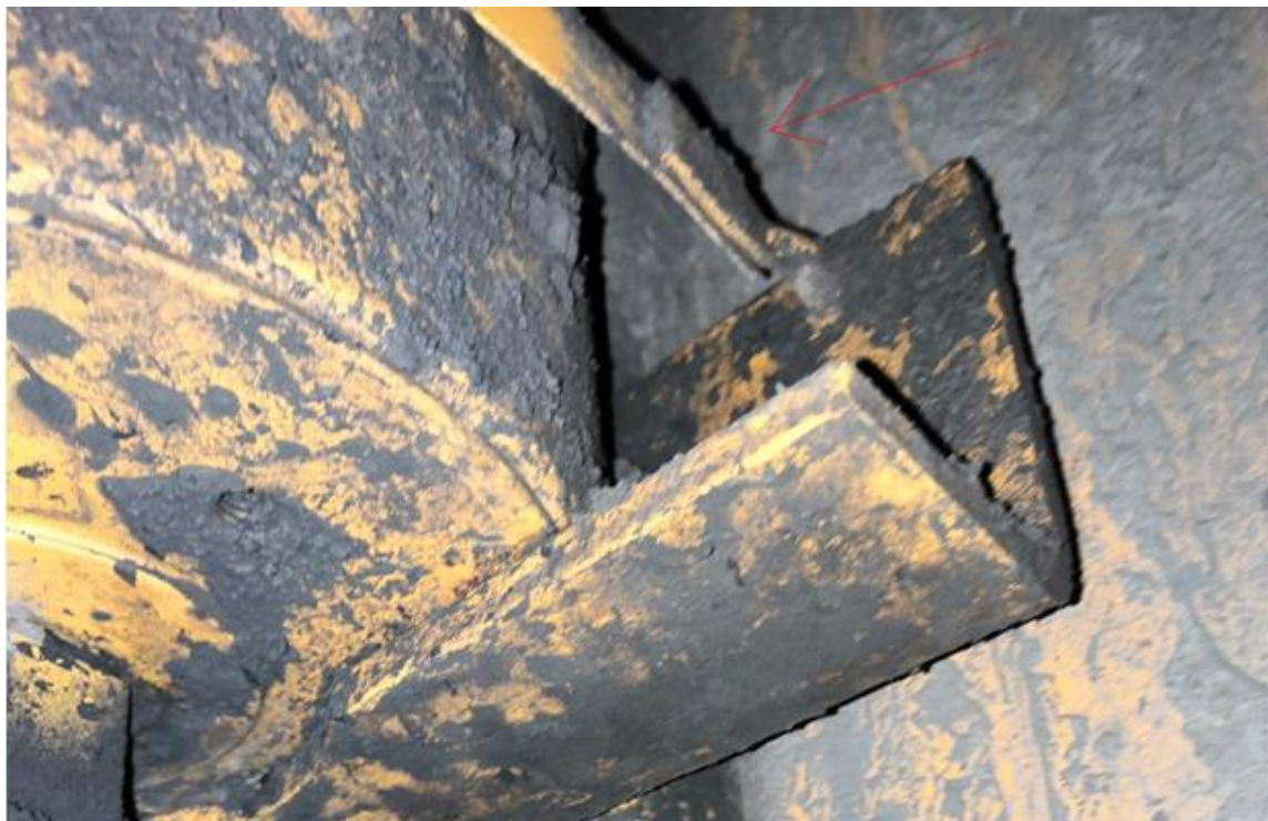
Рис. 2. Место наиболее частого повреждения хомутов крепления пневмогидроаккумуляторов к раме автосамосвала БелАЗ-7530 (указано стрелкой).
