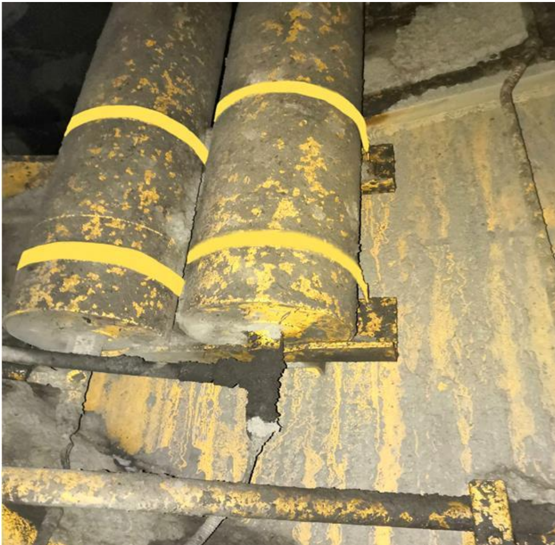
Рис. 1 Крепление пневмогидроаккумуляторов к раме автосамосвала БелАЗ-7530.
