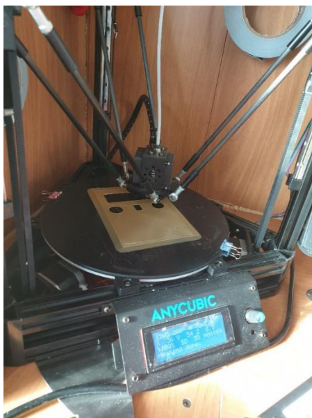
Рис. 3. Печать корпуса на 3D-принтере
