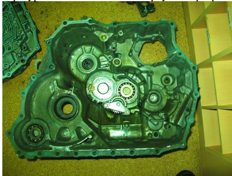
Рис. 4 Загрязнения деталей АКПП
