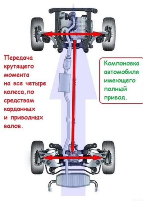
Рис. 5 Компоновка автомобиля с полным приводом
