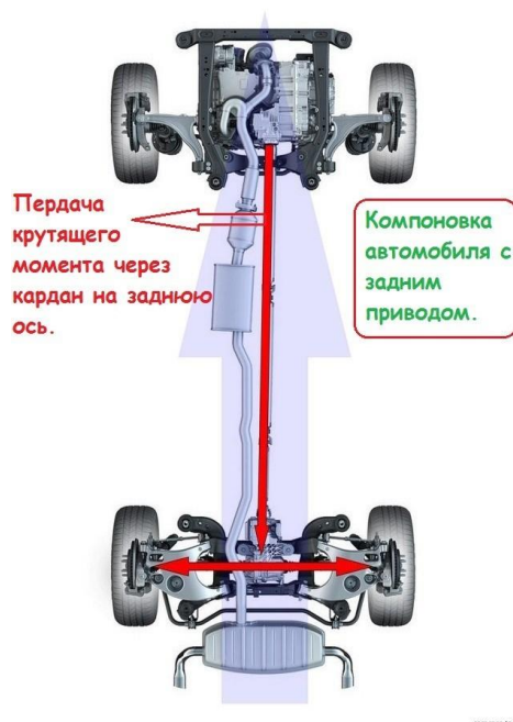
Рис. 3 Компоновка автомобиля с задним приводом
