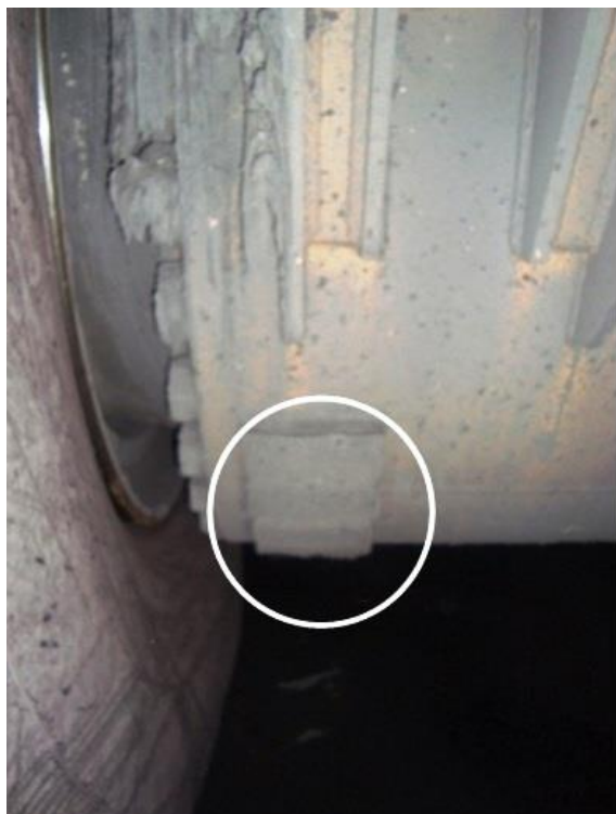
Рис. 3. Усиление на заводском шве (картер заднего моста)
