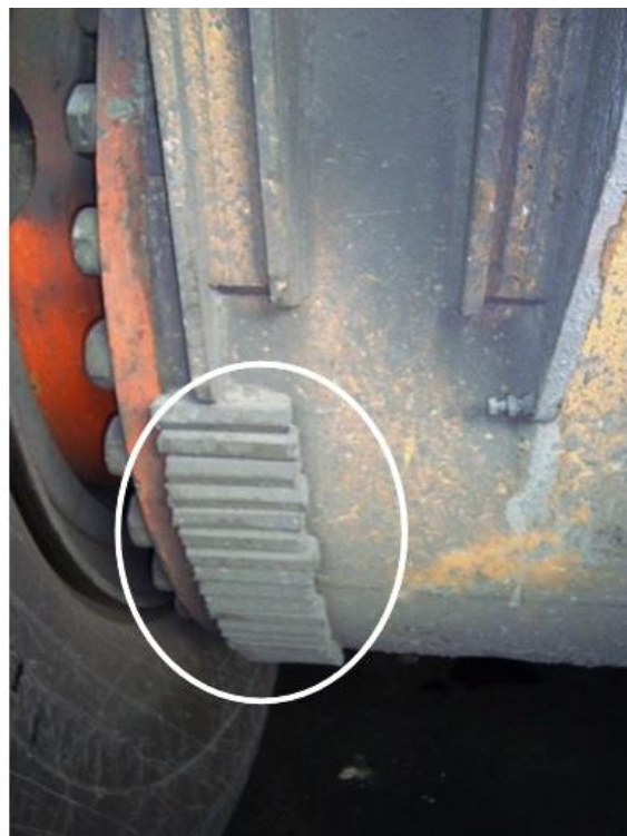
Рис. 3. Усиление на заводском шве (картер заднего моста)
