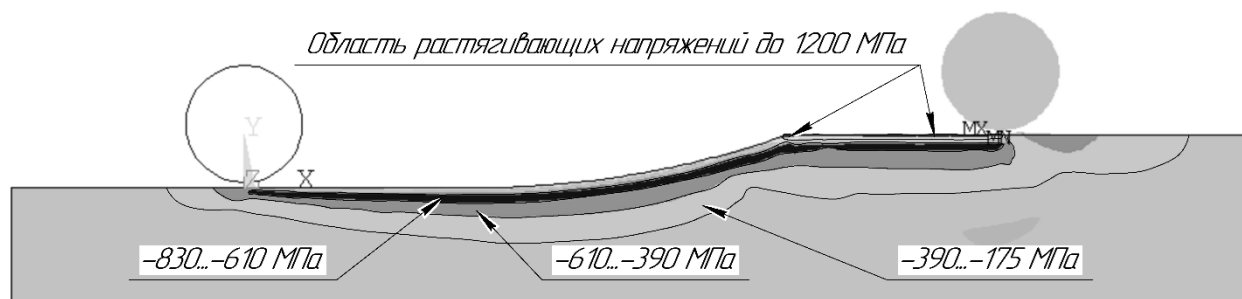
Рисунок 1 – Распределение напряжений осевого компонента \sigma_x после последнего шага моделирования
