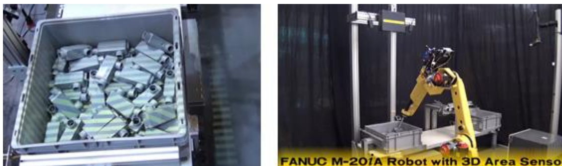
Рисунок 1. - Использование 3D-сканирования для извлечения предметов из бункера промышленным роботом
