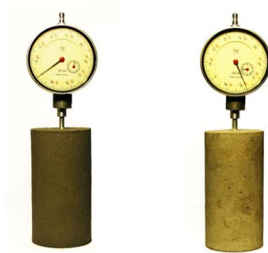
Рис. 3. Измерение линейных деформаций образца
