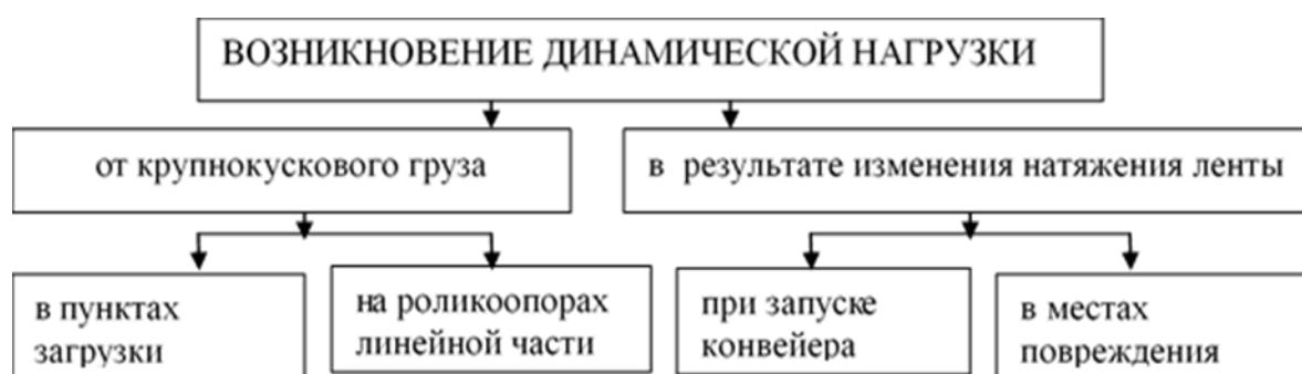
Рисунок 1- Классификация динамических нагрузок на конвейерную ленту в шахтных условиях
