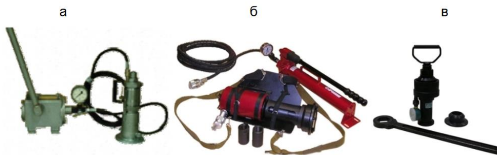
Рисунок 4. Приборы для проверки прочности закрепления анкерных стержней: а – ВШГ-20; б – ПКА-3; в – ПКА-1.
