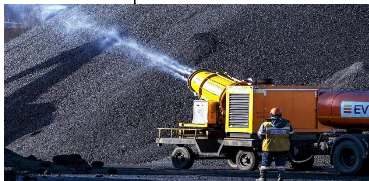
Рис. 4. Применение туманообразователей на Междуреченских разрезах
