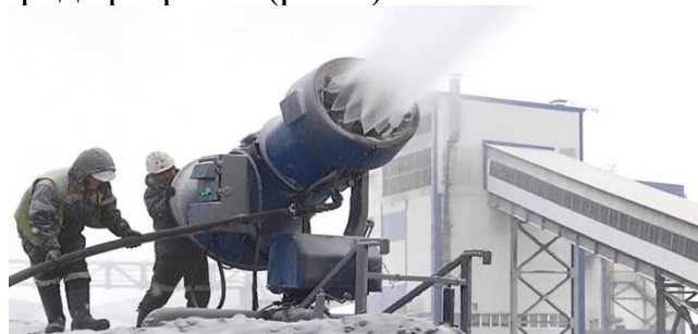
Рис. 2. Использование мобильных снегогенераторов на разрезе «Березовский»
