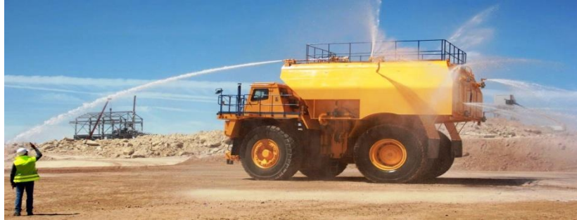
Рис. 1. Орошение взрывных блоков и их сейсмоопасных зон
