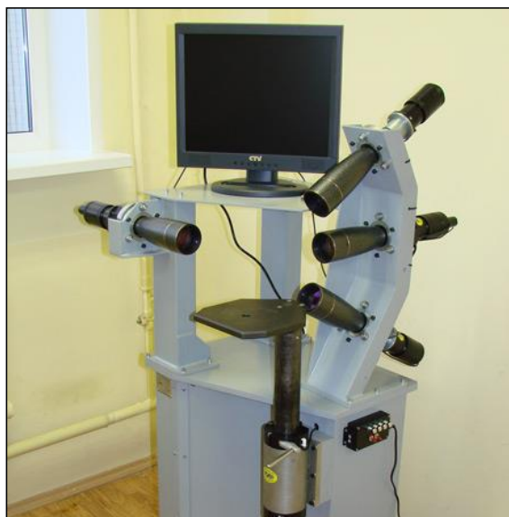
Рис. 3. Универсальный коллиматорный стенд ВЕГА УКС
