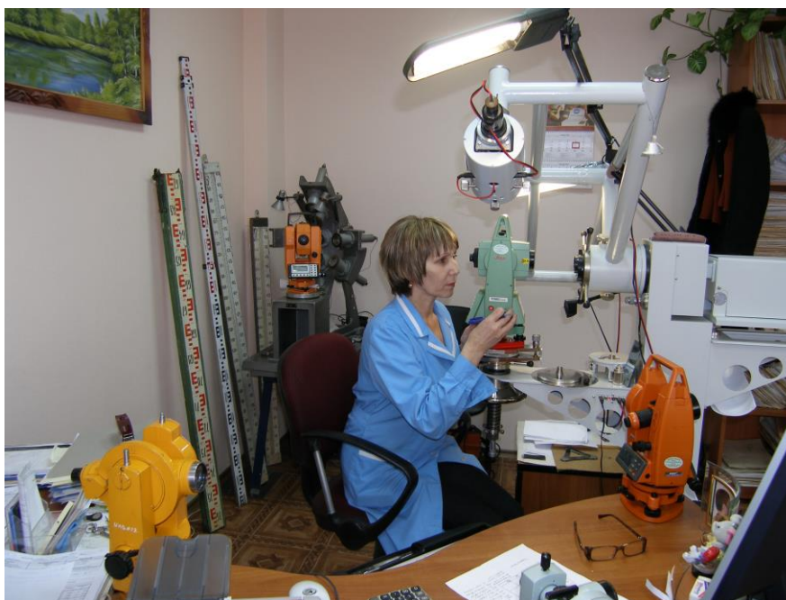
Рис. 2. Установка автоколлимационная для поверки нивелиров и теодолитов АУПН
