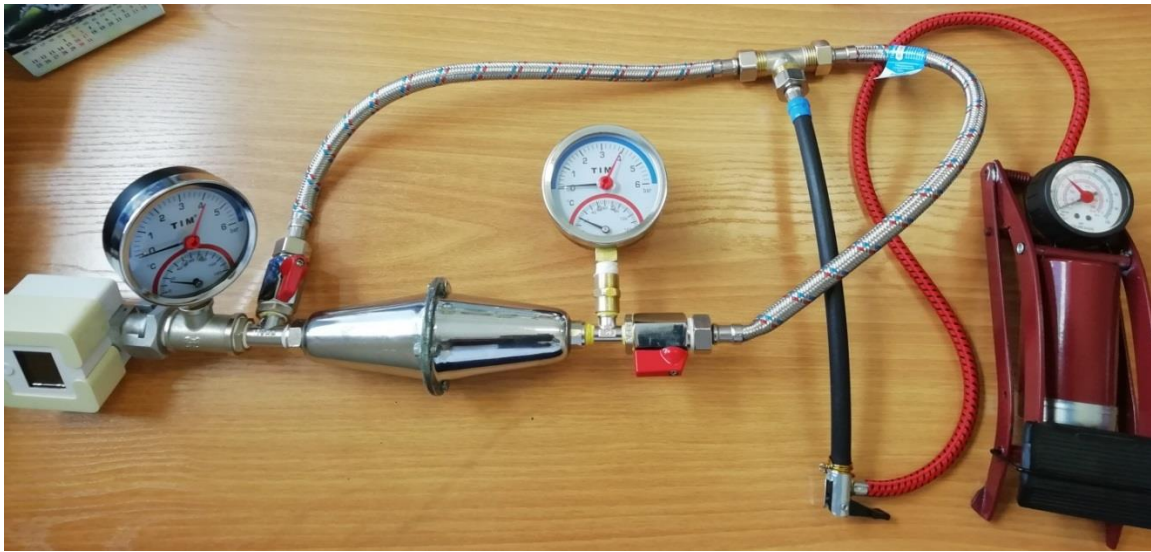
Рис.1. Схема установки для определения коэффициента проницаемости горных пород
