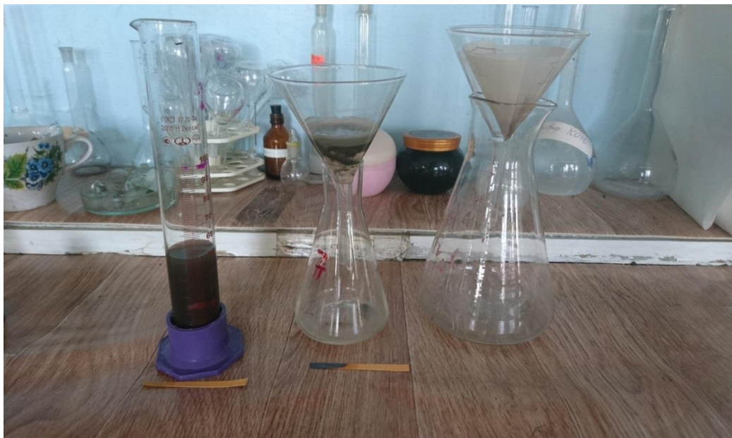
Рис.5. Результаты рН (рН = 6 (нейтральная среда) у осветленного стока; рН = 12 (сильнощелочная среда) у стока, пропущенного через золу).
