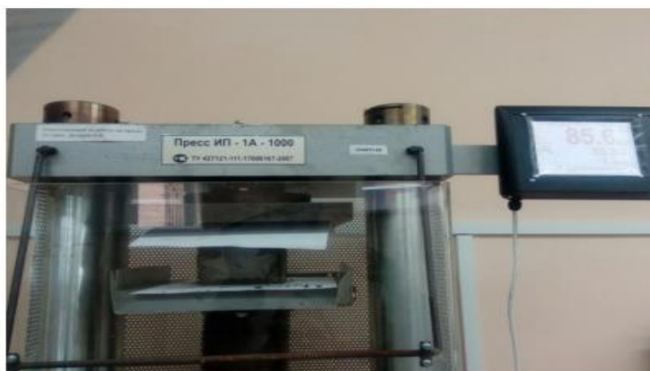
Рис. 3. Испытание образцов на сжатие
