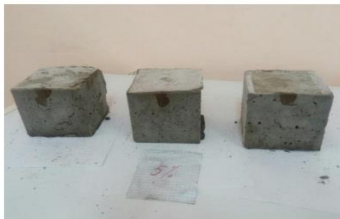
Рис. 2. Опытные образцы с добавкой хлористого натрия
