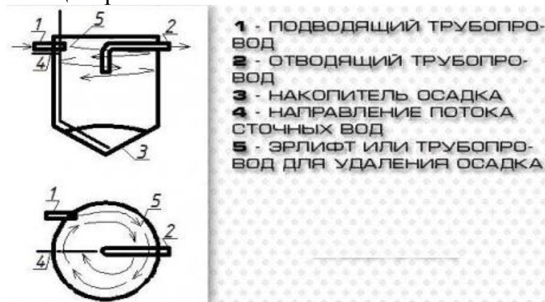
Рисунок 4- Тангенциальная песколовка
