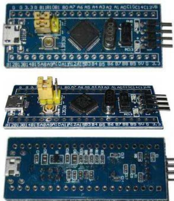
Рисунок 1. Внешний вид платы STM32F103C8T6
