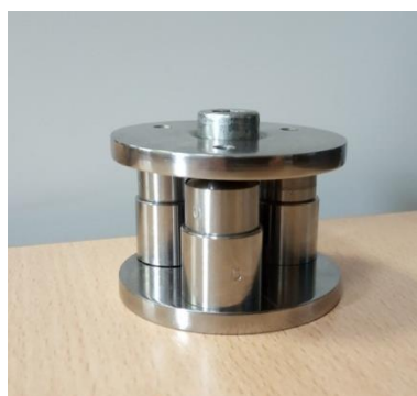
Рис. 8. Пресс-формы при испытании на герметичность.
