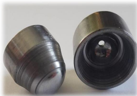
Рис. 6 Пресс форма после полировки
