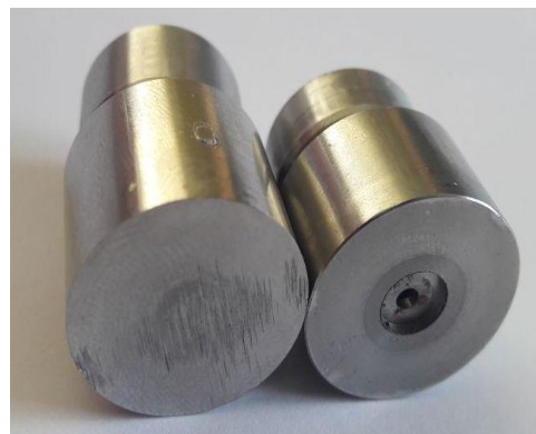
Рис. 3. Пресс-формы (слева старый образец, справа новый образец)
