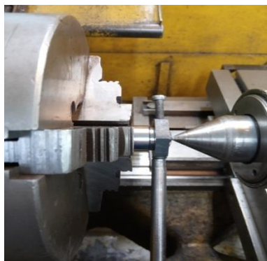
Рис. 7 Процесс притирки пресс-форм.
