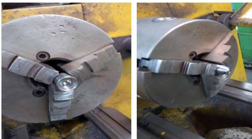
Рис. 5 Полированные детали на станке TUM - 35.
