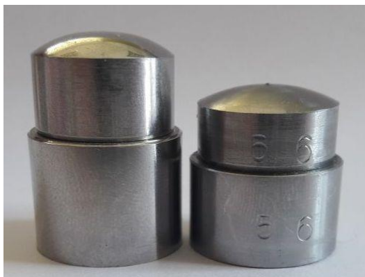
Рис. 3. Пресс-формы (слева старый образец, справа новый образец)
