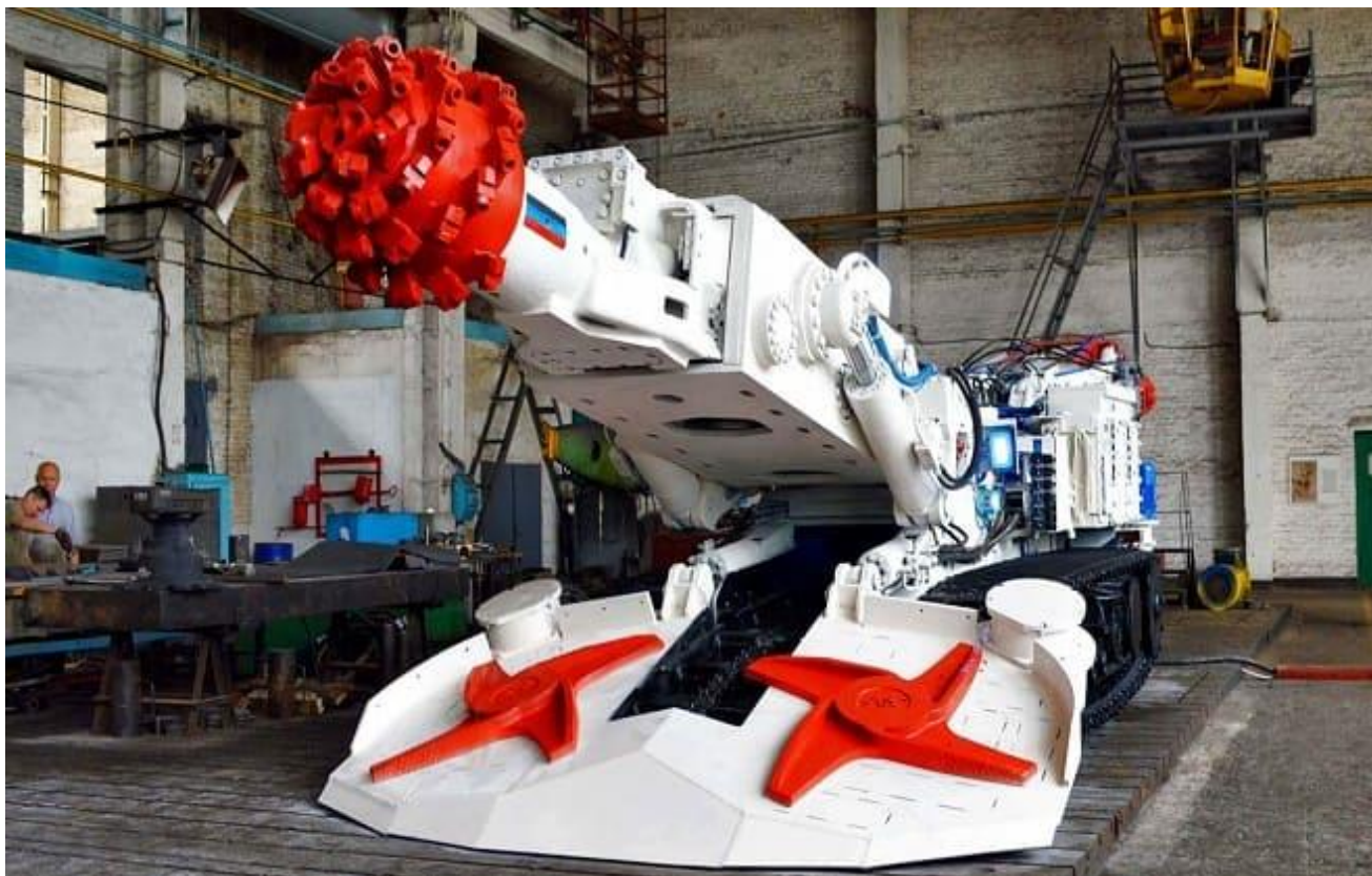
Рис 1. Проходческий комбайн КП-21.
