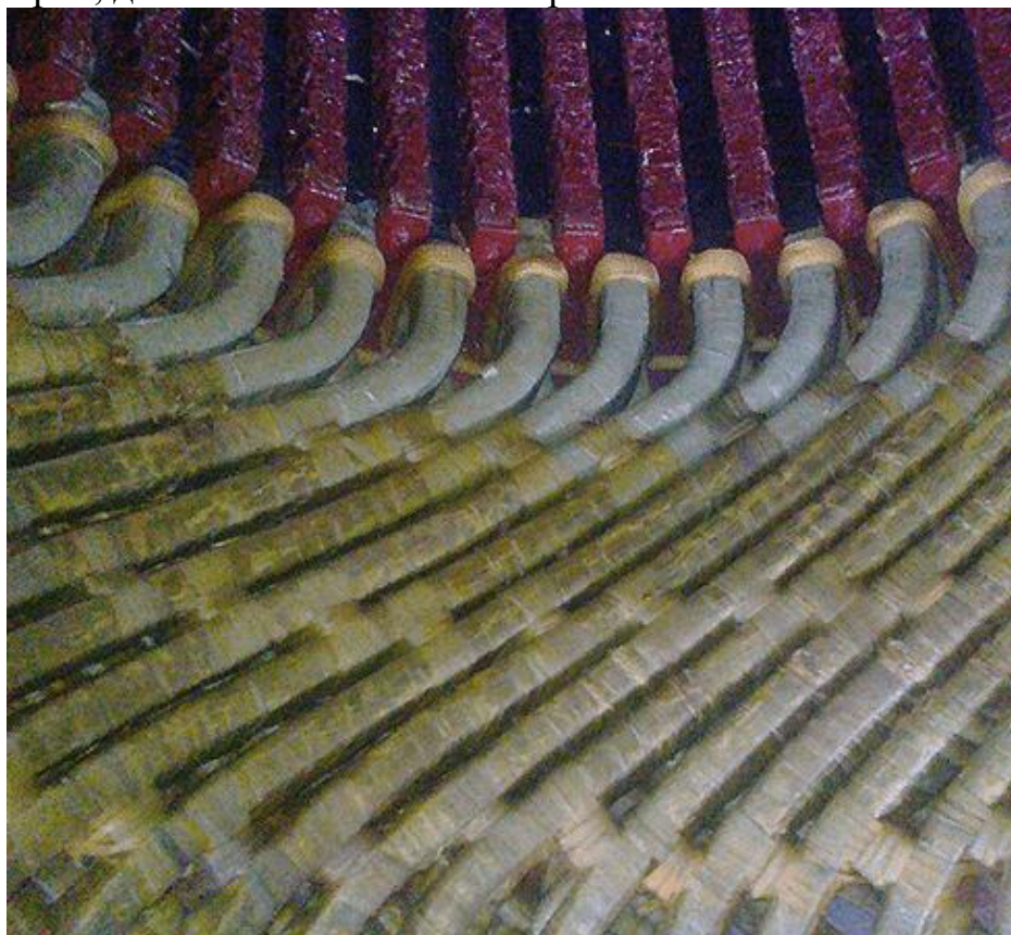
Рисунок 2 – Изоляция «Монолит-4» после запечки
