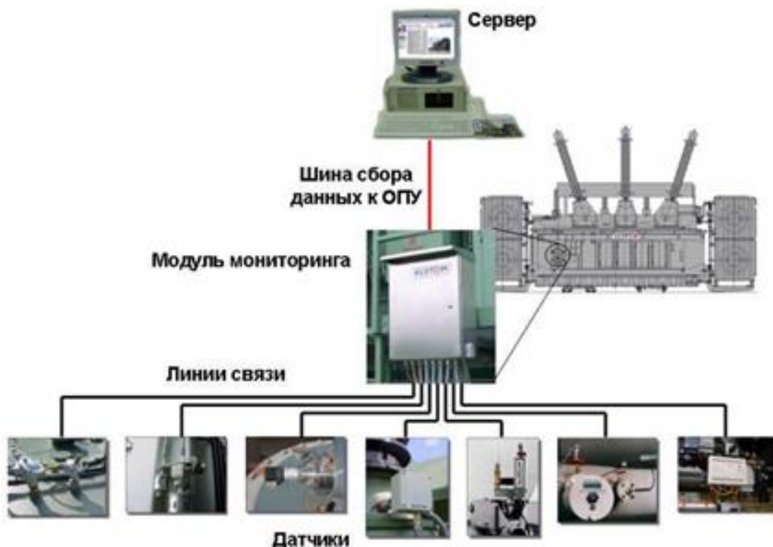
Рисунок 1. Типовая архитектура СМ
