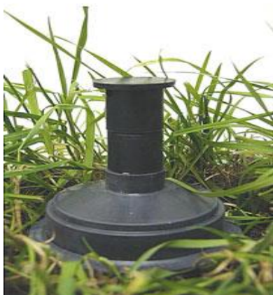
Рис. 1. Накопительная камера НК-32 с активированным углем
