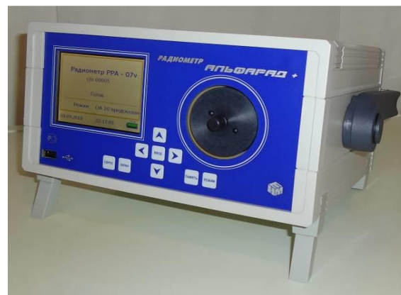
Рис. 2. Комплекс измерительный для мониторинга радона, торона и их дочерних продуктов "Альффард плюс"
