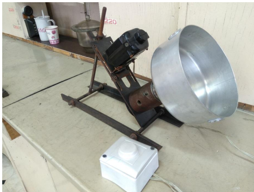
Рис.1. Лабораторный тарельчатый гранулятор
