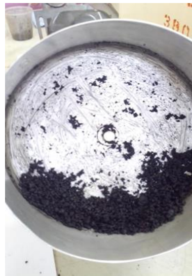
Рис. 2. Гранулообразование при влажностью шлама 23 %
