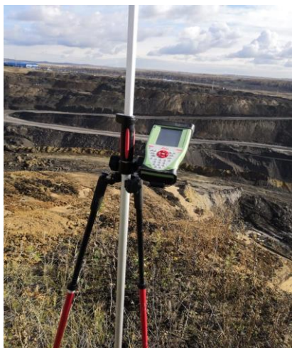
Рис.3. GPS- наблюдения за процессом сдвижения
