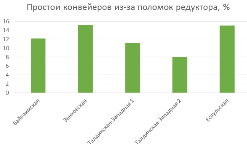
Рис. 1. – Гистограмма усредненного по годам процента отказов редукторов ленточных конвейеров
