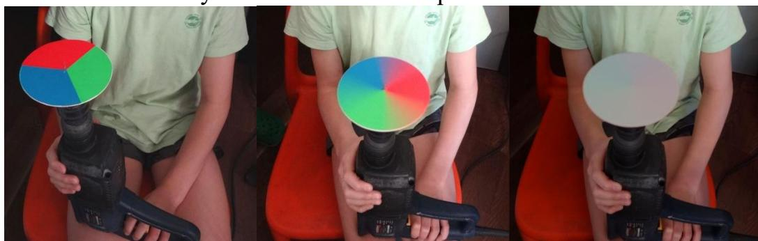
Сделаем из плотного картона круг, разделенный на секторы красного, синего и зеленого цвета. При помощи шуруповерта приведем диск во вращение. Когда диск вращается медленно, мы видим отдельные цвета. Но при достижении определенной скорости вращения мозг уже не может их разделить, и цвета сливаются в один, который принимается мозгом за белый (или, точнее, за оттенок светло-серого).
