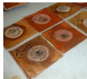
Рис. 2. Вспучивание покрытия силикатной краски во время горения гофрокартона
