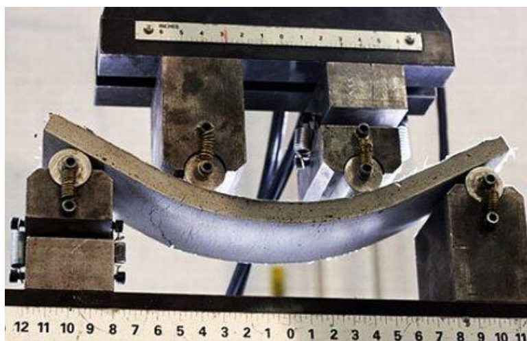
Рис.1. Испытание самовосстанавливающегося бетона на изгиб.
