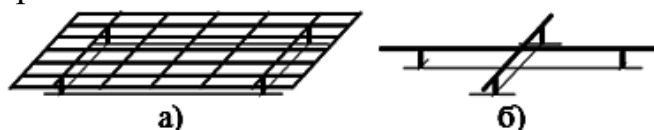
Рис.1. Схемы приведения структуры к плоской расчетной схеме: а - структура, как 2 группы взаимно-перпендикулярных ферм, б - взаимно-перпендикулярные фермы.
