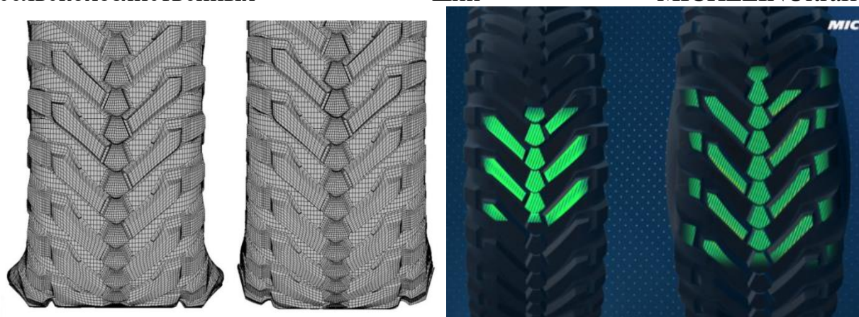
Рис. 9 Шины Michelin Ultraflex при низком и нормальном давлениях.
