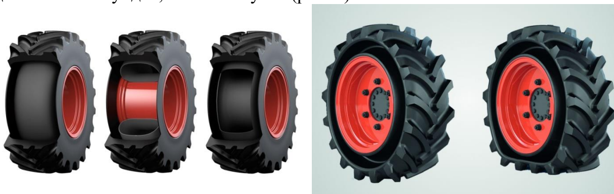
Рис. 7 Инновационные шины Mitas Aircell
