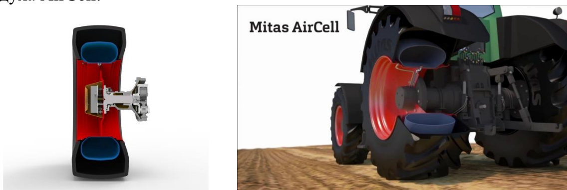
Рис. 8 Принцип работы шины Mitas Aircell
