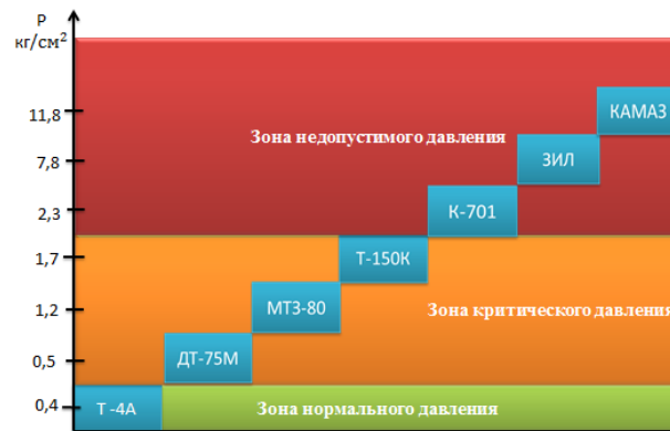
Рисунок 2 - Воздействие движителей на почву.
